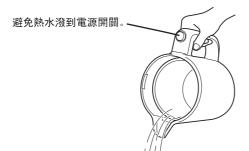
握持把手再延著注水口慢慢將熱水倒出。請小心熱水飛濺造成的燙傷。
