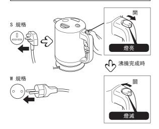
情先確認電源開關是否切換為「關」 後,再將電源插座上的電源插頭拔除。
