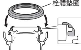
安裝栓體墊圈時，確保其沿正確方向完全嵌入就位。
