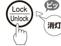
「ピッ」と音がして、「ロック解除」ランプが消灯します。「給湯」キーがロックされ、押しても給湯ができません。
